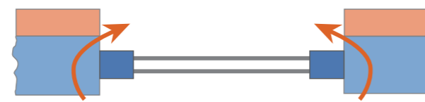
Konstruktionsbedingte Wärmebrücke mit seitlich entweichendem Wärmestrom
